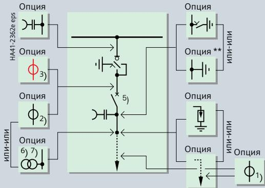
**Тип LS11** С вакуумным силовым выключателем ЗАН6, съёмный шириной 750 мм
