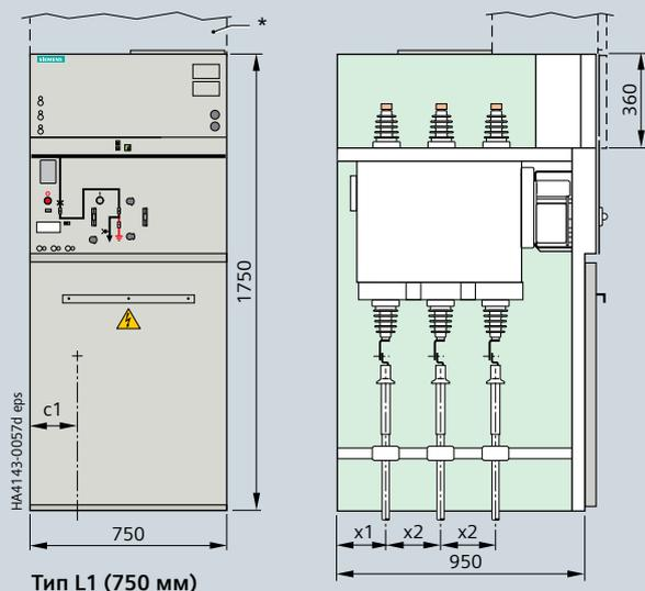
Ячейка с силовым выключателем 630 А, 1250 А
