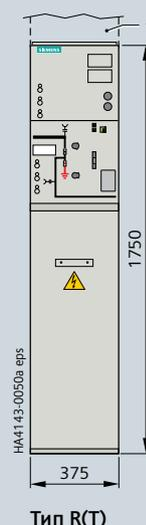
Ячейка с выключателем нагрузки, тип R(T), для сочетаний ячеек в качестве переходной ячейки слева тип R(T) (расположена на левой стороне сочетания ячеек)
