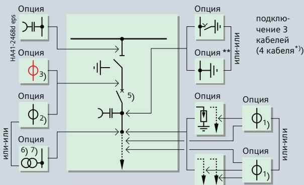
**Тип LS32** С вакуумным силовым выключателем ЗАН6, съёмный шириной 825 мм
