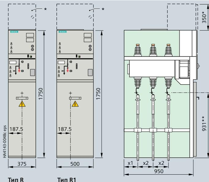
Ячейки с выключателем нагрузки
