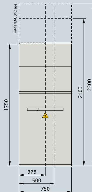
Высота распределительного устройства 1750 мм
