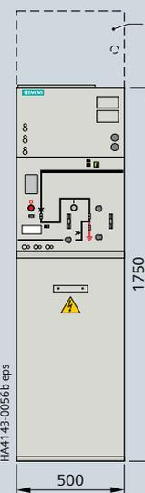
Тип L(T) в качестве переходной ячейки, расположенной справа
