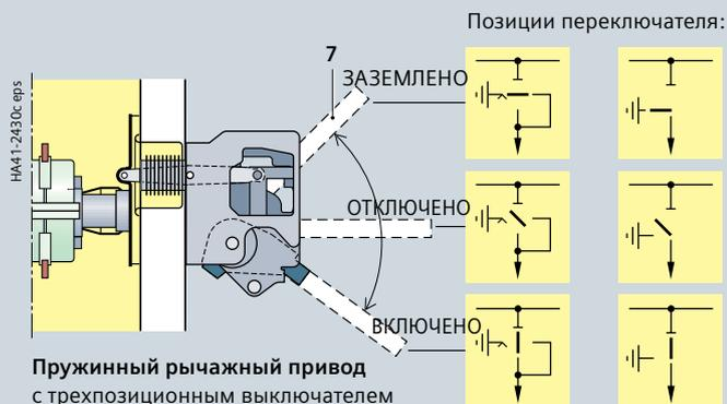
Пружинный рычажный привод с трехпозиционным выключателем
