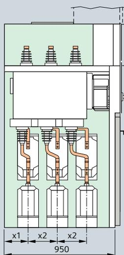
Сочетание ячеек секционного выключателя
