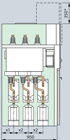
Сочетание ячеек секционного выключателя
