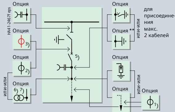
**Тип LS31** С вакуумным силовым выключателем ЗАН6, съёмный шириной 750 мм
