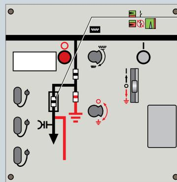
Передняя панель управления ячейки трансформатора
