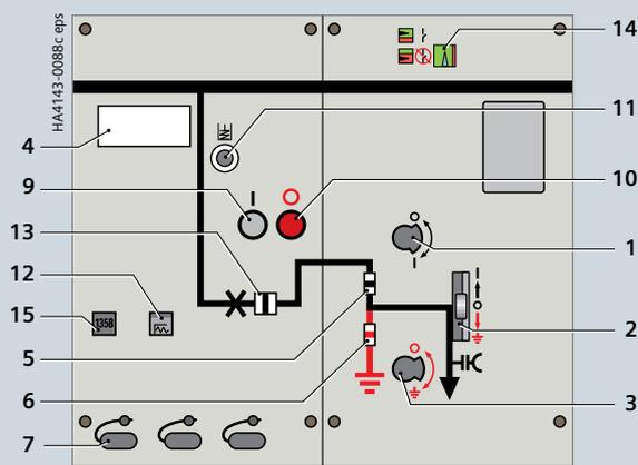
Ширина ячейки: 500 мм, с силовым выключателем, тип CB-f AR \*)
