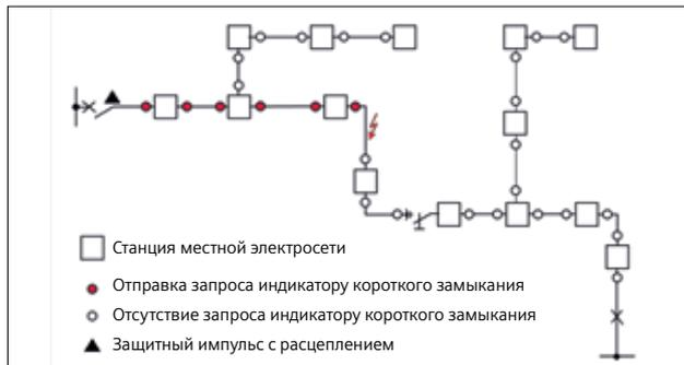
Индикаторы короткого замыкания/индикаторы замыкания на землю могут применяться в радиальных электросетях и в открытых кольцевых сетях. Все индикаторы короткого замыкания могут применяться в низкоомных сетях с неподвижно соединенным заземлением в качестве индикаторов замыкания на землю.
