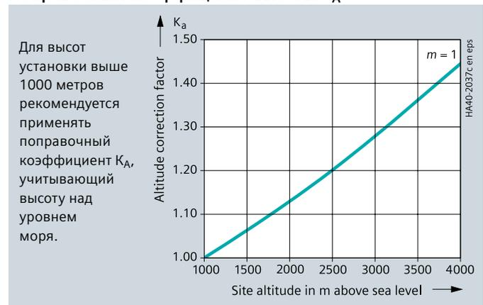
Номинальное кратковременное предельное переменное напряжение для высот установки свыше 1000 метров выбирается следующим образом
