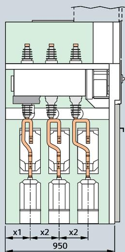
Сочетания секционных ячеек с трансформаторами напряжения: переходная ячейка с выключателем нагрузки, тип R(T), и переходная ячейка тип Н и двух переходных ячеек с выключателями нагрузки, тип R(T)
