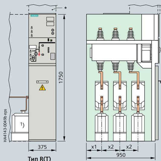
Ячейка с выключателем нагрузки, тип R(T), для сочетаний ячеек в качестве переходной ячейки справа, тип R(T) (расположена на правой стороне сочетания ячеек)
