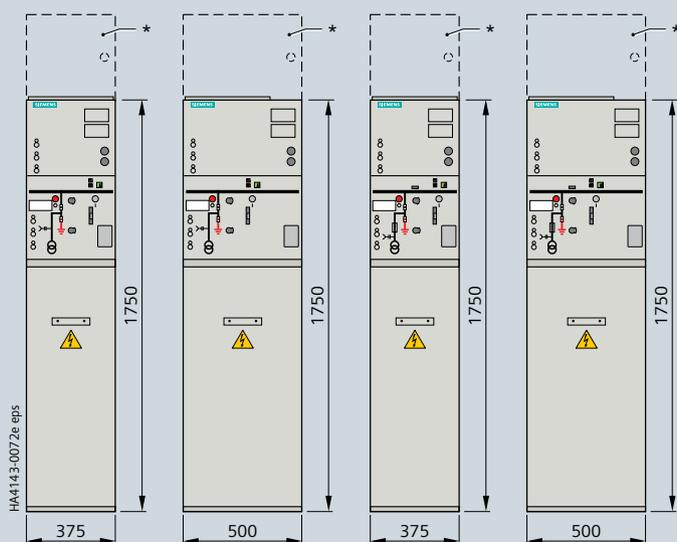
Тип М(VT)    Тип М1(VT)    Тип М(VT-F)    Тип М1(VT-F)
