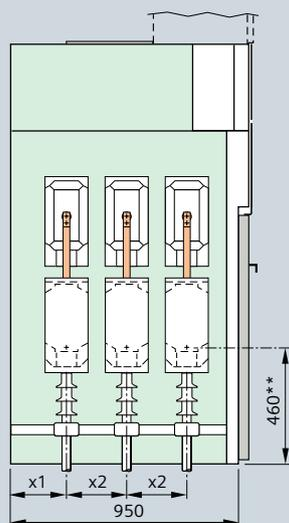
Измерительная ячейка, тип М(-БК)
