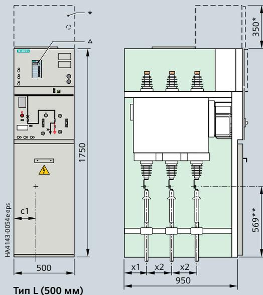
Ячейка с силовым выключателем 630 А
