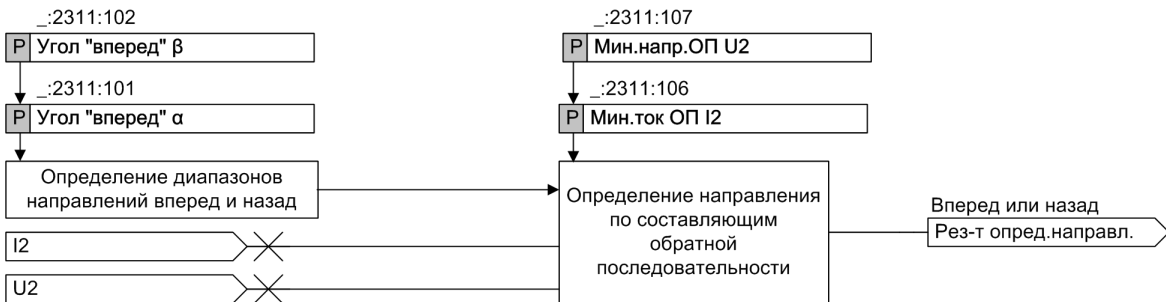
Рисунок 6-125 Логика определения направления
