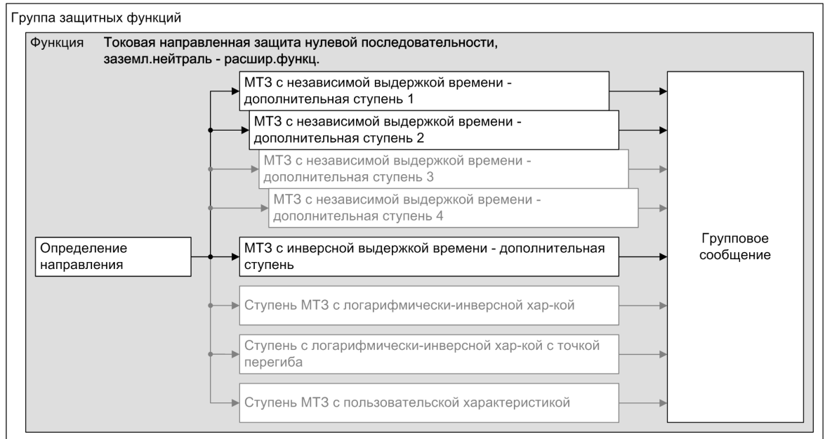
Рисунок 6-50 Структура/реализация функции направленной максимальной токовой защиты с независимой выдержкой времени (от КЗ на землю, расширенная функциональность)
