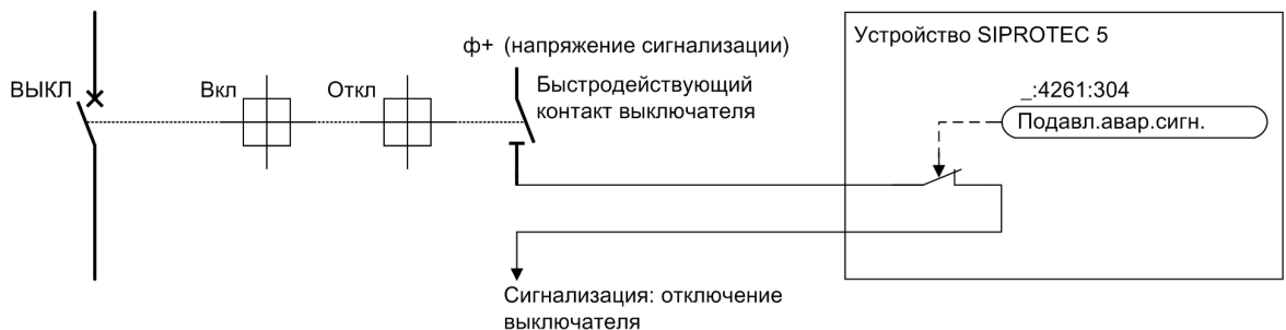
Рисунок 5-60 Подавление аварийной сигнализации при отключении выключателя
