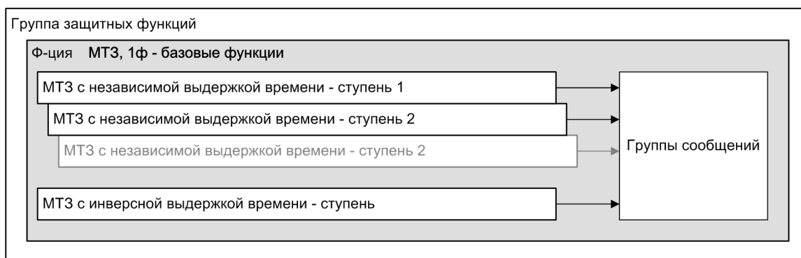
Рисунок 6-79 Структура/реализация функции MT3, 1-фазная — Базовая функциональность
