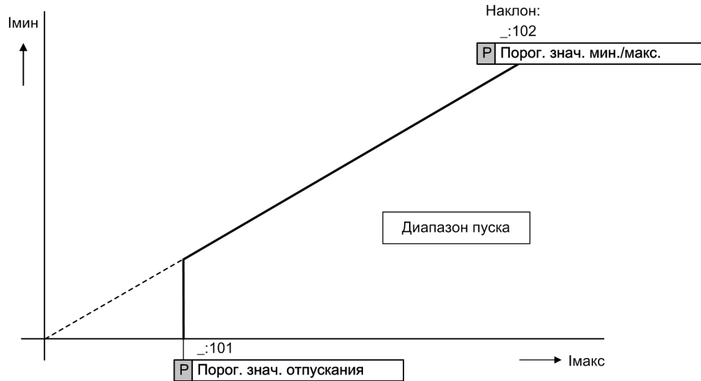
Рисунок 8-20 Характеристика контроля симметрии токов
