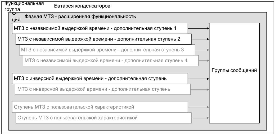
Рисунок 6-32 Структура/реализация функции МТЗ, фазы – Расширенная функциональность
