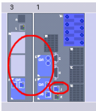
Рисунок 5-46 Подключение модуля Ethernet
