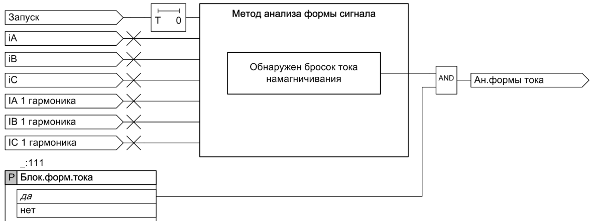
Рисунок 6-71 Логическая схема функции метода CWA (T=1 период)
