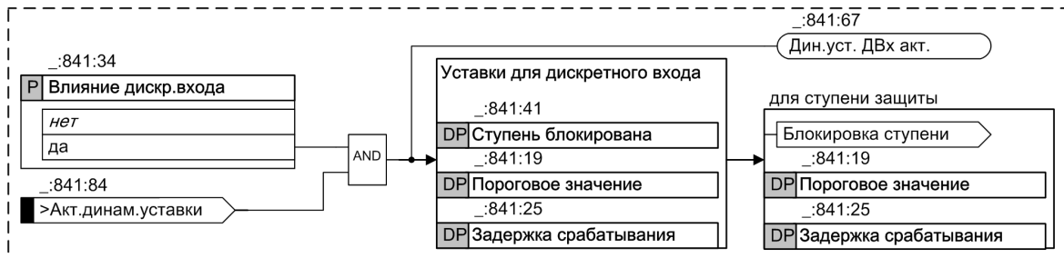
Рисунок 6-31 Влияние дискретного входа на ступень максимальной токовой защиты
