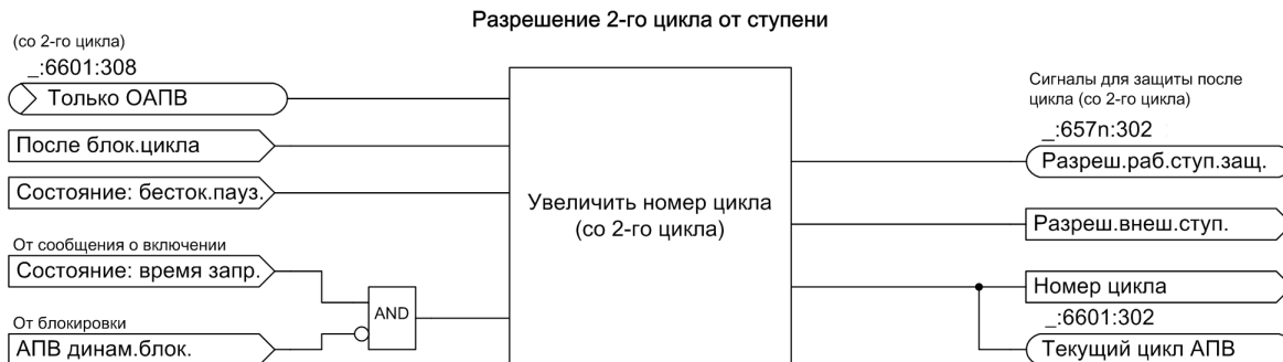
Рисунок 6-234 Логическая схема работы функционального блока Разрешение работы ступени для 2-го и последующих циклов АПВ.
