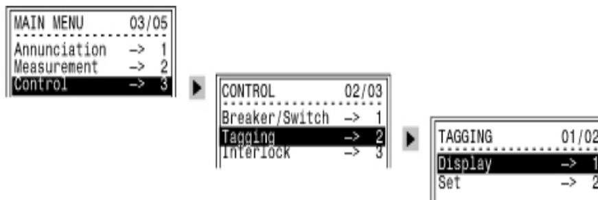
Рисунок 7-52 Установка меток на Оборудование через Переднюю Панель
