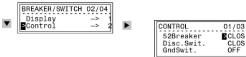
Рисунок 7-44 Управление Коммутационным Оборудованием через Переднюю Панель
