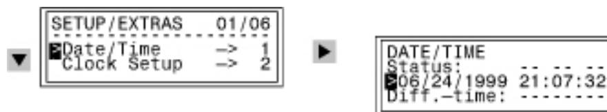
Рисунок 7-30 Ручная настройка Даты и Времени через Переднюю Панель
