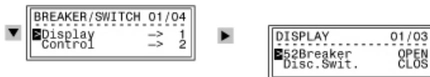
Рисунок 7-43 Отображение положений коммутационного оборудования на ЖКИ (пример)
