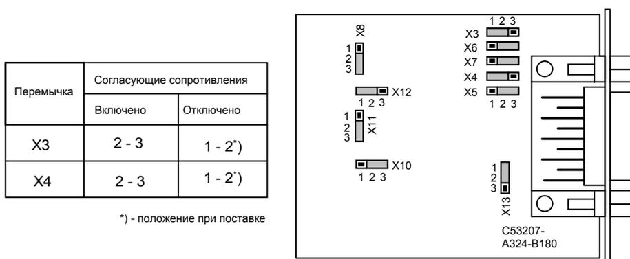
Рисунок 8-11 Расположение переключателей для установки согласующего сопротивления интерфейса.
