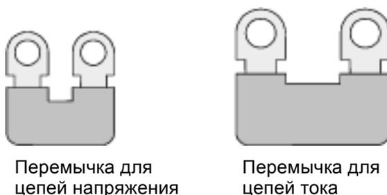
Рисунок 2-25 Перемычки для использования в цепях напряжения и для использования в токовых цепях
