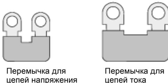
Рисунок 2-8 Перемычки для использования в цепях напряжения и для использования в токовых цепях
