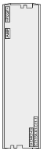
Защитная крышка для блоков с 18 клеммами цепей напряжения
