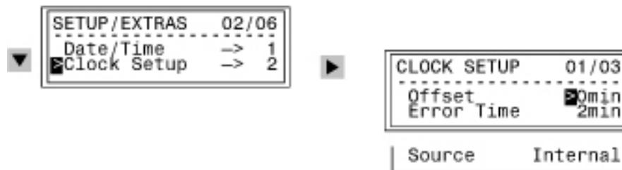
Рисунок. 7-31 Установка Параметров Управления Датой и Временем через Переднюю Панель
