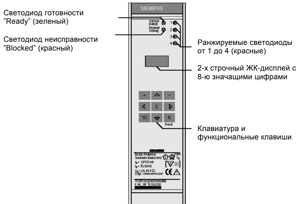
Рисунок 3-1 Вид спереди измерительной системы 7SS601 с клавиатурой и дисплеем
