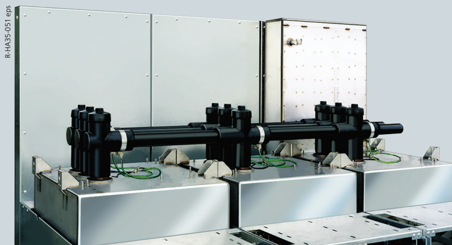
Сборные шины 1250 А, втычные, полностью изолированные (вид спереди на ширину трех ячеек, без отсеков низкого напряжения)
