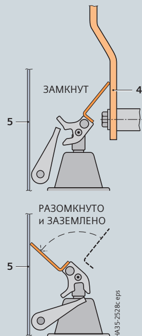
Устройство разъединения для трансформатора напряжения фидера (увеличенное изображение Z)
