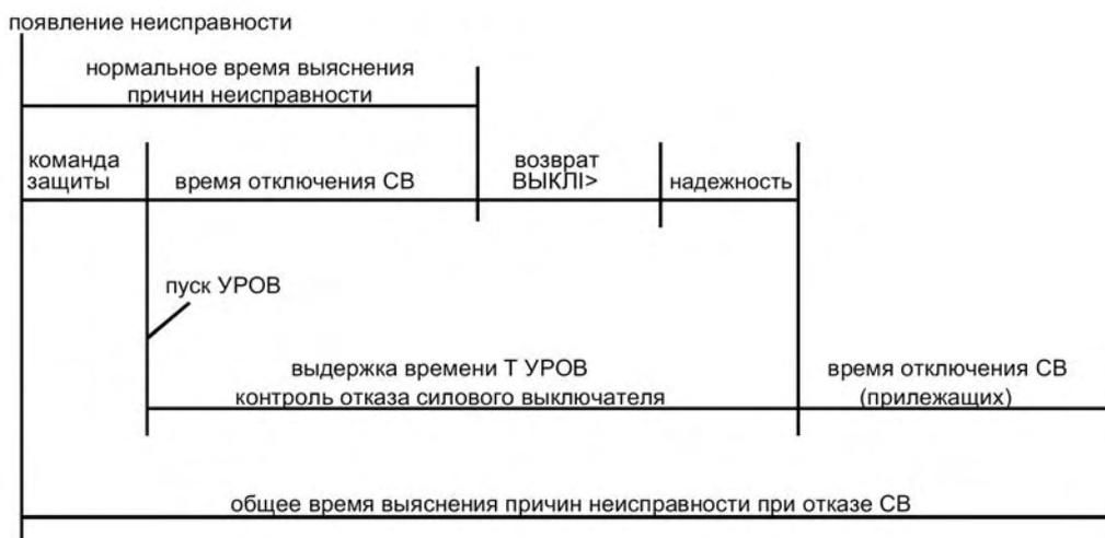
Рисунок 6.8 Течение времени при нормальном устранении причин неисправности и при действии функции устройства резервирования отказа силового выключателя
