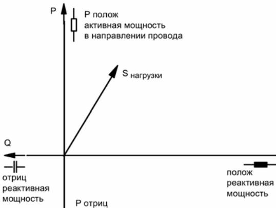
Рисунок 6.11 Полная мощность нагрузки
