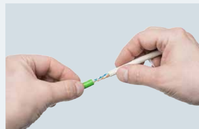
Удалите оплетку и снимите витой экран
