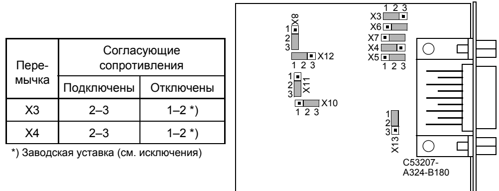
Рисунок 3-10 Расположение переключки на модуле интерфейса RS485
