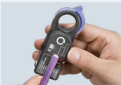
Зачистка и сборка с помощью M12 разъема
