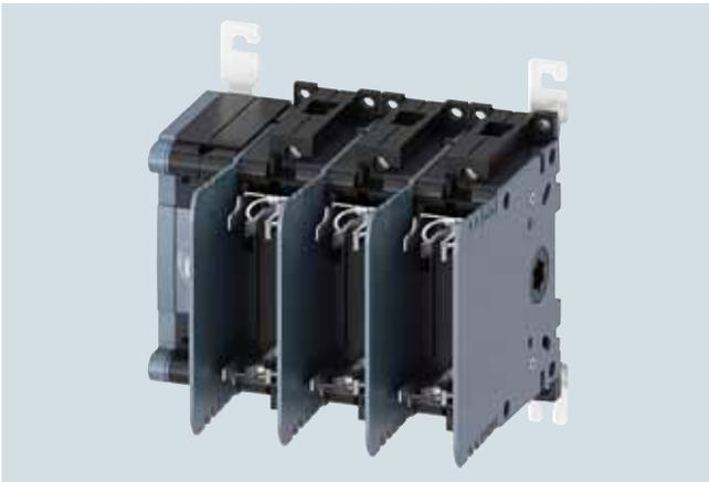
Выключатель-разъединитель с предохранителями ЗКФ SITOR **NEW**, базовый, 3-полюсный, фронтальный привод, привод справа, типоразмер 1, рамочные зажимы
