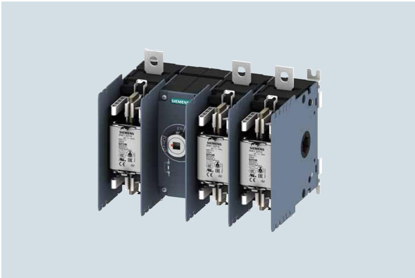
Выключатели-разъединители с предохранителями ЗКФ защищают низковольтные цепи от перегрузок и коротких замыканий и используются в качестве главных, аварийных и ремонтных выключателей в распределительных устройствах, щитах, на линиях электроснабжения и линиях питания электродвигателей. В зависимости от типоразмера они позволяют включать и отключать токи в диапазоне от 32 до 800 А.
