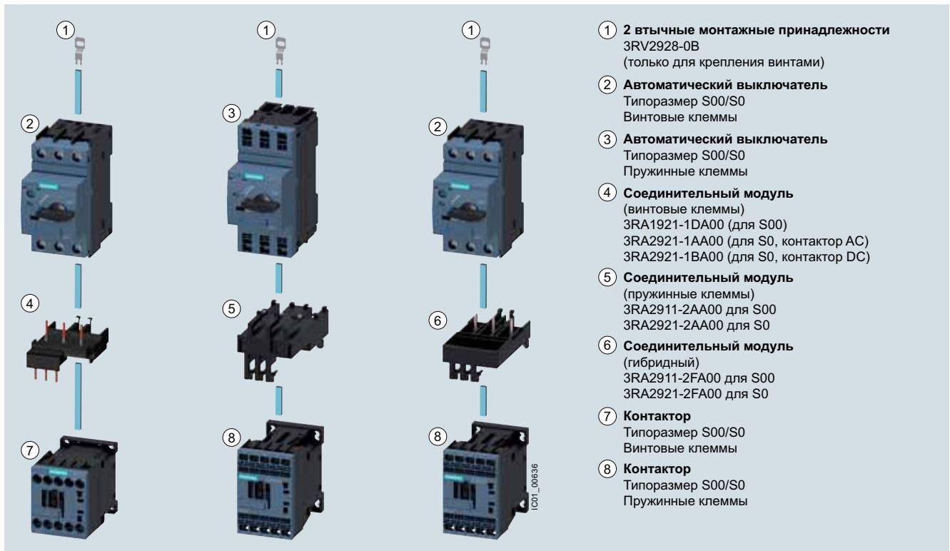
Слева: Пусковая сборка 3RA21 с винтовыми клеммами В центре: Пусковая сборка 3RA21 с пружинными клеммами Справа: Сборка из автоматического выключателя с винтовыми клеммами и контактора с пружинными клеммами
