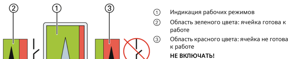
Рисунок 103:Индикатор готовности к эксплуатации (герметичность резервуара) (опция)
