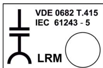
Рисунок 47: Место для отметок о повторных проверках состояния устройства контроля
