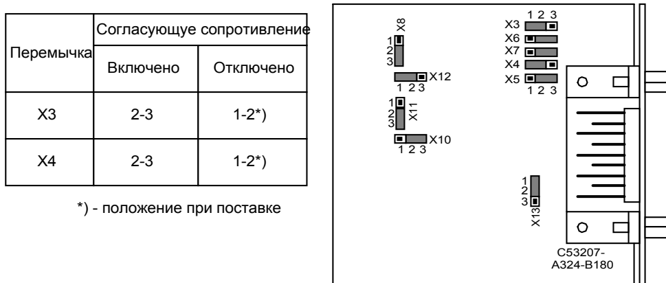
Рисунок 8-8 Расположение переключателей для установки согласующего сопротивления интерфейса версии C53207-A322-B180.
