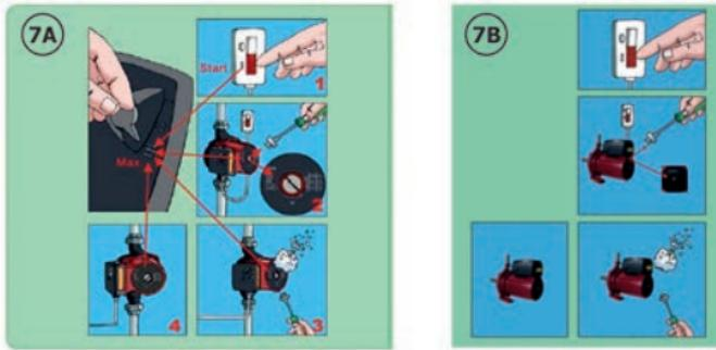
Подать напряжение и установить переключатель в положение «Max», выкрутить винт для удаления воздуха, защитив электрические части от попадания жидкости или пара. После того, как вода, выходящая из насоса, перестанет содержать воздух, винт завернуть.
