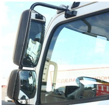
Подогреваемые двухсекционные зеркала бокового обзора
