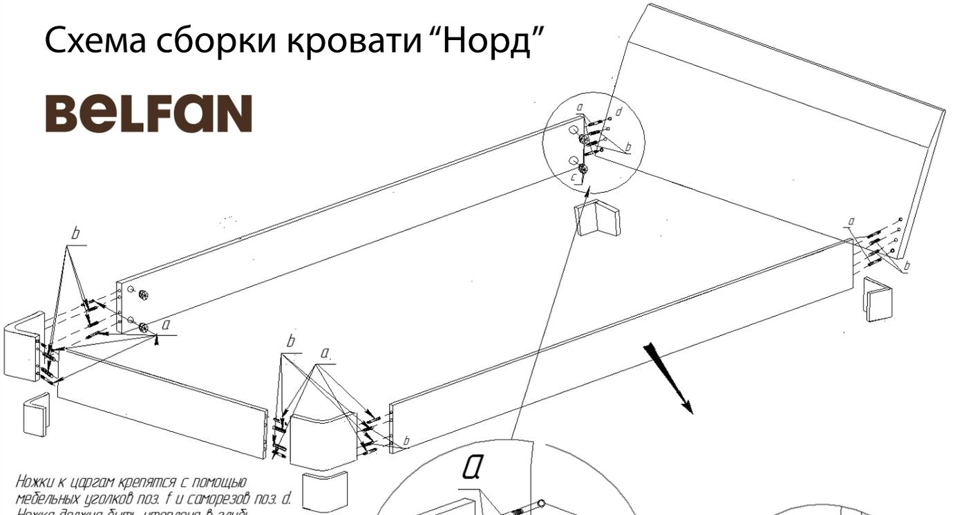
Ножки к царгам крепятся с помощью мебельных уголков поз. f и саморезов поз. d. Ножка должна быть утоплена в глубь кровати на расстояние достаточное для крепления уголка.
