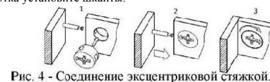
Рис. 4 - Соединение эксцентриковой стяжкой.
