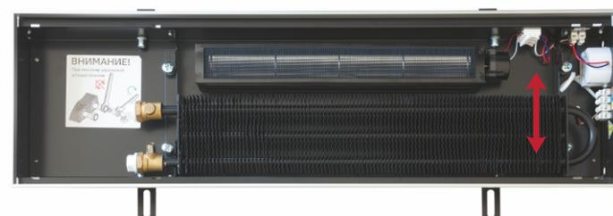
Теплообменник можно сместить вверх или вниз и установить вентилятор для увеличения теплоотдачи. Блок питания и клеммные колодки поставляются в комплекте с вентилятором.
