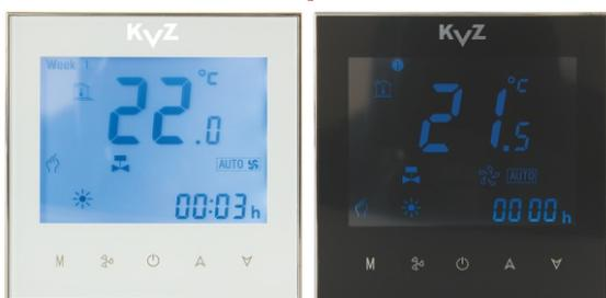
Комнатные термостаты поддерживают заданную температуру в помещении, регулируя скорость вращения вентиляторов в конвекторах и управляя сервоприводом. Термостат можно запрограммировать на включение и выключение в определённое время, экономя тепло в будни. Термостат устанавливается в стандартный подрозетник и питается от сети ~230 В.
