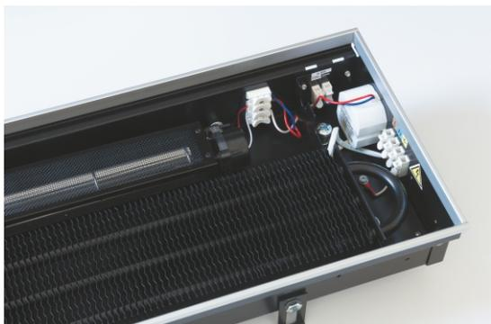
За счет применения 12-ти коллекторного двигателя постоянного тока и виброподвеса крыльчатки уровень шума ЕС-вентилятора составляет всего 19 дБ на максимальных оборотах. Поэтому возможна установка конвекторов с такими вентиляторами в спальнях и детских комнатах.
