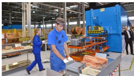
Теплообменники изготавливаются на итальянском оборудовании из бесшовной медной трубы и гофрированных алюминиевых пластин. Каждый теплообменник перед установкой в конвектор проходит проверку давлением, что гарантирует отсутствие протечек.
