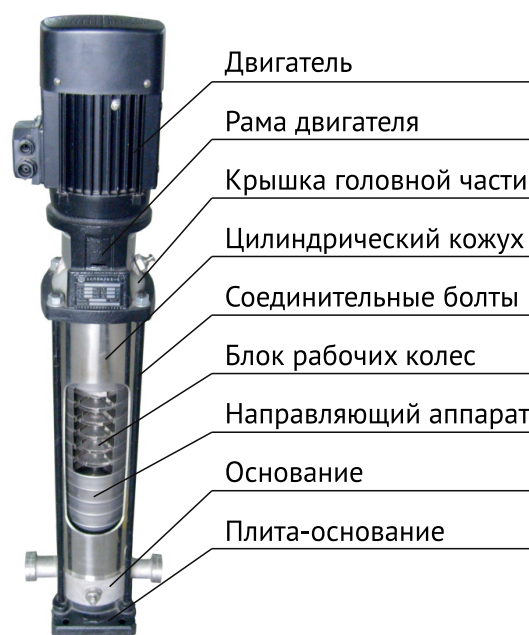
Рис. 3. Конструкция насосов
