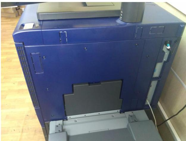
2.Снимаем мет. Крышку над байпасом. На ней залитыми винтами закреплен хоппер .
