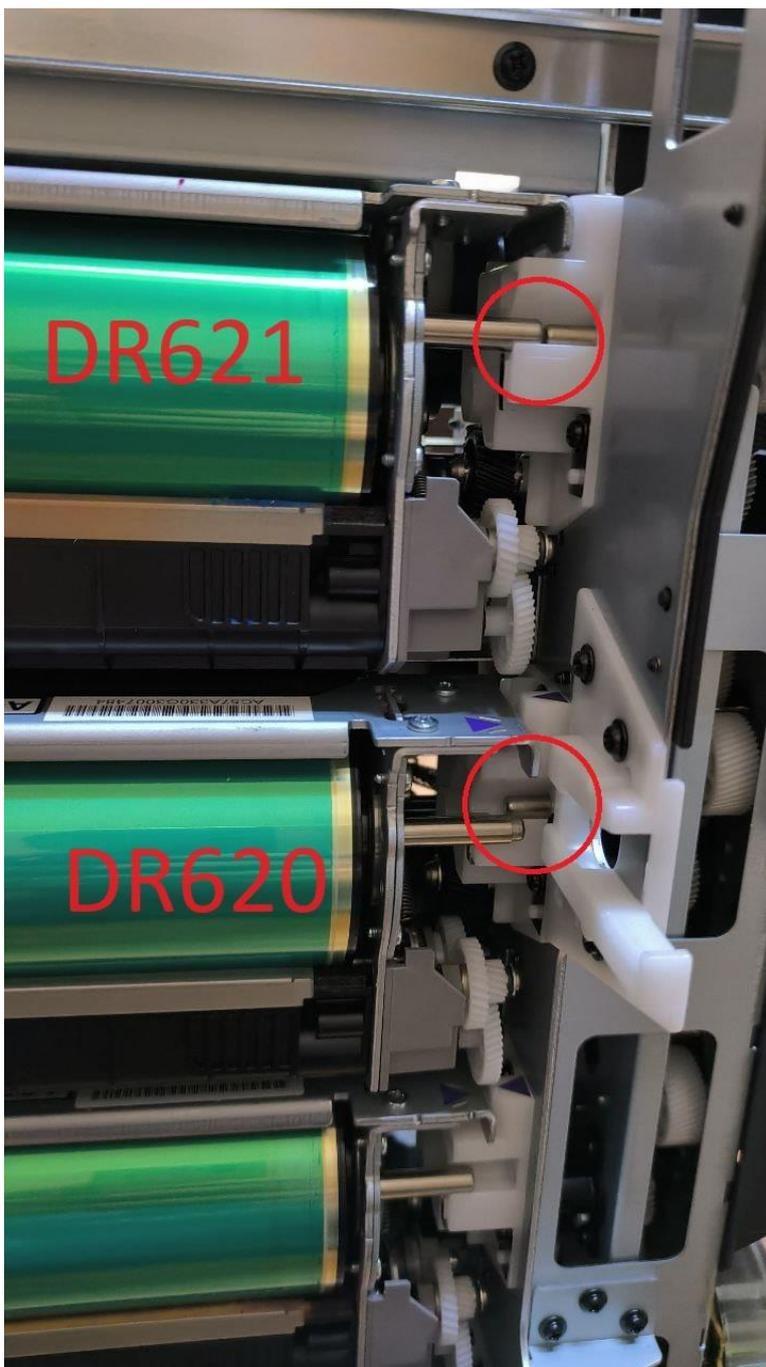
Удаляем ответный штырь в машине, и подходят любые барабаны. Для того, чтобы было удобней, снимаем шестеренку привода шнека барабана и белую пластиковую накладку. Плоскогубцами аккуратно достаём штырь, он просто завальцован. Собираем назад.
