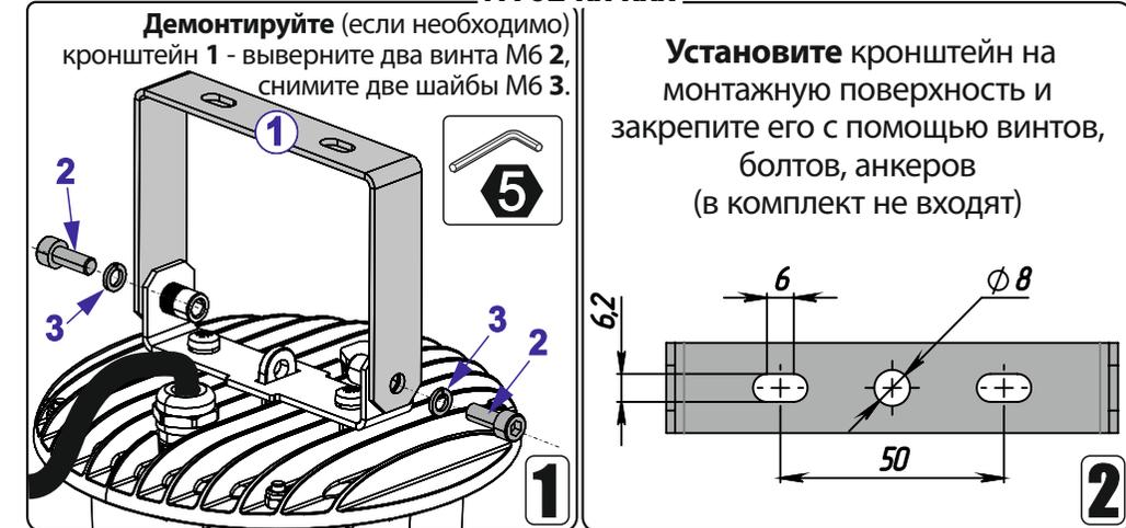
**3** Закрепите светильник на кронштейн(FA 02-xx-xxx, рис.1), выберите необходимый угол наклона и зафиксируйте его.
