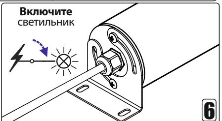
В модификациях с дополнительным выводом(димминг, АБ) соответствующий провод светильника имеет этикетку с цветовой маркировкой сигналов управления и его подключение необходимо производить согласно информации на ней.
