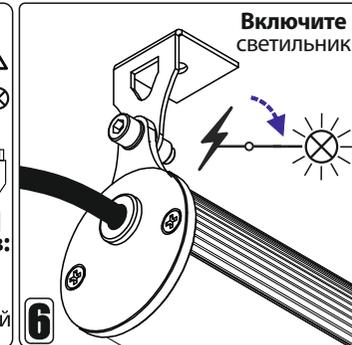
⚠ В модификациях с диммигом соответствующий провод светильника имеет этикетку с цветовой маркировкой сигналов управления и его подключение необходимо производить согласно информации на ней.
