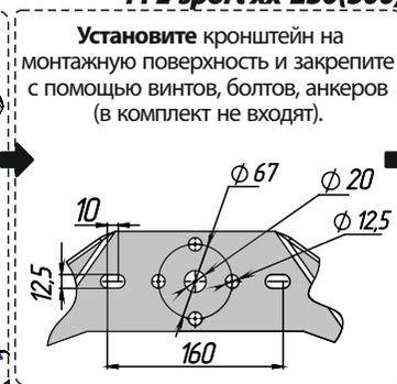
Установите и закрепите прожектор на кронштейн. Выберите необходимый угол наклона и зафиксируйте прожектор.
