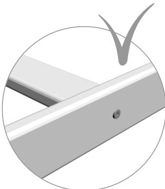
После сборки и регулировки производим затяжку винтов
