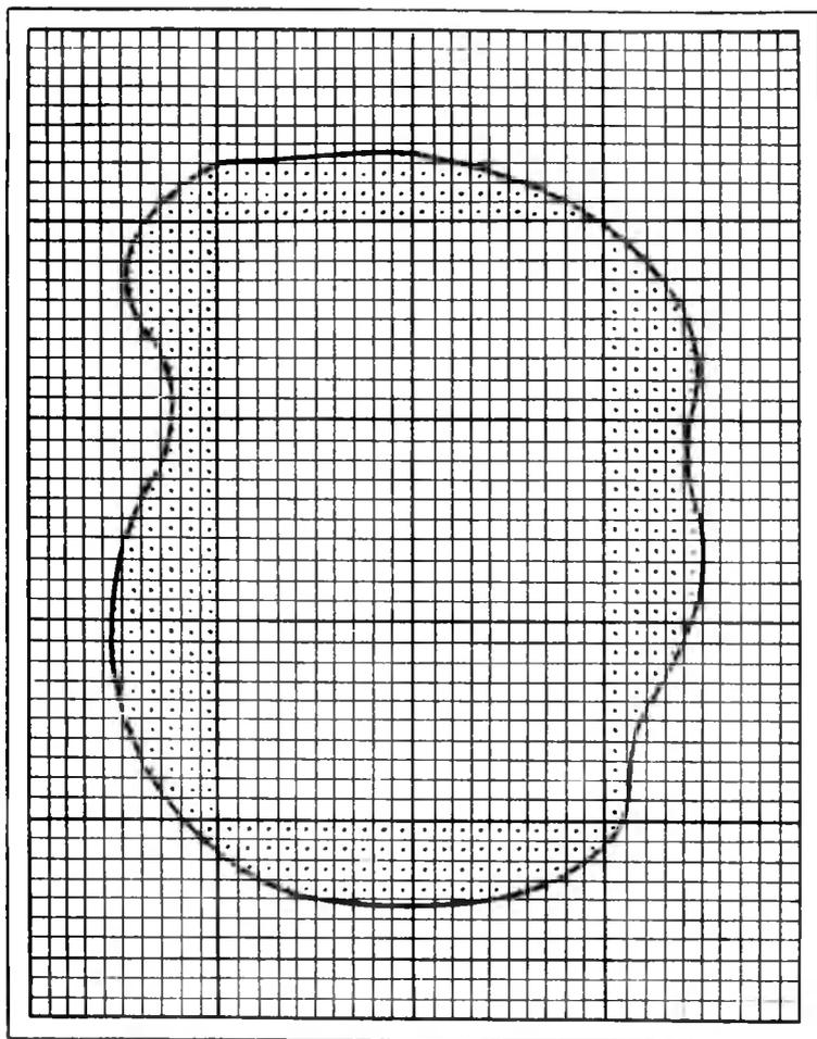
Рис. 41 Измерение площади при помощи палетки
