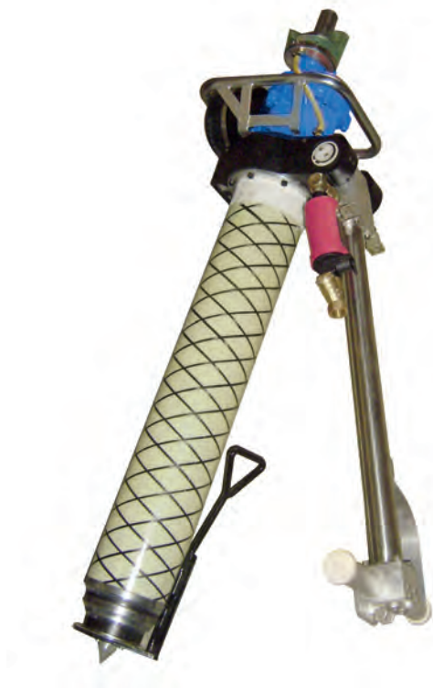
Установки бурильные (анкероустановщики) вертикального типа MQT - 120, 130
