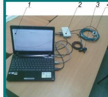
Аппаратно-программный комплекс контроля параметров колесных машин, оснащенных ДВС с искровым зажиганием: 1 - нетбук; 2 - быстродействующая система сбора и обработки данных; 3 - модифицированный датчик положения коленчатого вала; 4 - высокоточный цифровой расходомер топлива.
