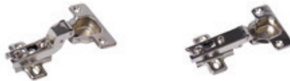
Все створки кухни «Мари» оснащены четырех-шарнирными петлями. Основой такой петли является корпус с механизмом из двух рычагов. Одна сторона каждого из них жестко закреплена на корпусе модуля шарниром, а другая удерживает чашку петли, которая устанавливается в отверстие на внутренней стороне открываемой двери. Механизм устроен таким образом, что рычаги имеют два фиксированных положения, в которых чашка располагается параллельно или перпендикулярно корпусу.
