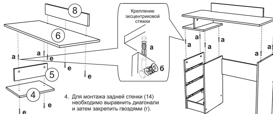
4. Для монтажа задней стенки (14) необходимо выровнять диагонали и затем закрепить гвоздями (г).
