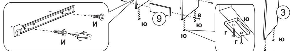
2. Боковины (1,2) соединяем с цоколем (9) и планкой (13). После чего боковину (2) крепим к боковине (3) при помощи вязки (7). Крепление осуществляем еврошурупами (е).
