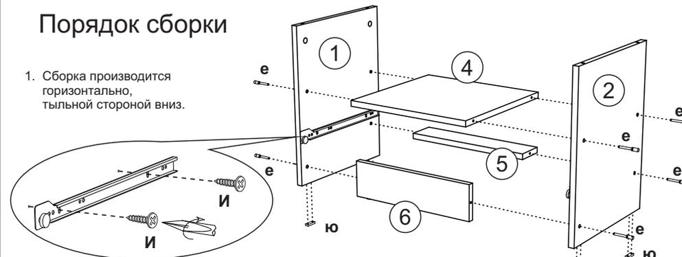
2. Предварительно к боковинам (1,2) фиксируем роликовые направляющие (о) шурупами 4x16 (и) и к торцам крепим подпятники (ю) гвоздями (г).
