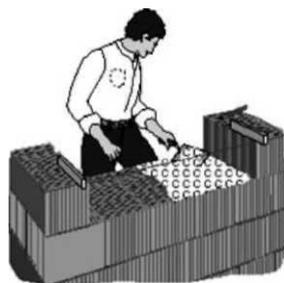
Раствор постельного шва наносится по всей поверхности до наружных граней стены, но не должен выступать наружу, поэтому лишний раствор, вытекающий из постельного шва, убирается с помощью лопатки.
