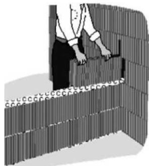
При соединении несущей перегородки из камней 6.87NF с периметральной стеной нанесите раствор на боковую сторону камня и прижмите камень этой стороной к периметральной стене. Через ряд нужно перевязывать шов несущей перегородки с периметральной стеной. Если предъявляются повышенные требования к звукопоглощающим свойствам кладки, то необходимо особо тщательно наносить раствор в швы между камнями.
