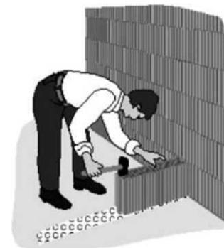
При соединении перегородки с несущей стеной на торцевые камни нанесите раствор на боковую сторону, уложите камень и прижмите его бок с нанесённым раствором к несущей стене. При таком типе стыка необходимо укреплять каждый второй постельный шов с помощью плоского анкера из нержавеющей. Согнутую под прямым углом горизонтальную часть анкера нужно вдавить в раствор постельного шва, а вертикальную часть -прикрутить с помощью шурупа и дюбеля к несущей стене.
