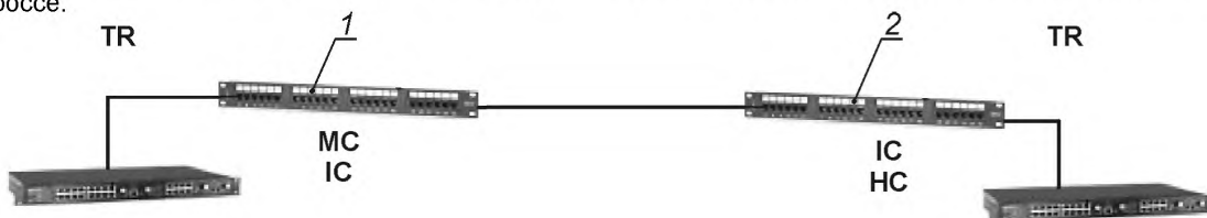
Рисунок 27 — Модель «постоянной линии» магистральной кабельной подсистемы (внешней или внутренней) с двумя точками коммутации
