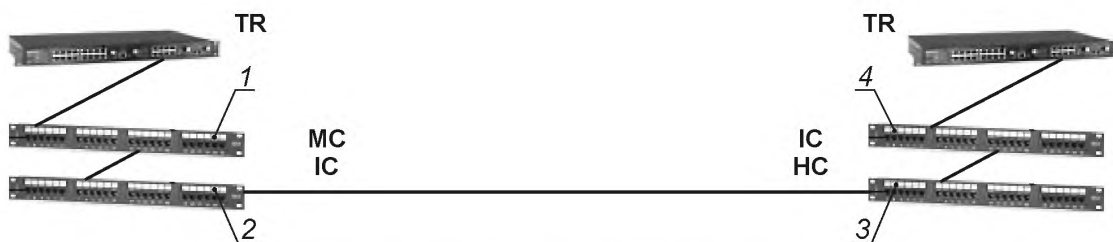
Рисунок 28 — Модель канала магистральной кабельной подсистемы с четырьмя точками коммутации
