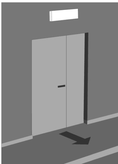
**Рисунок 5.9 – Расположение светильника эвакуационного освещения снаружи здания**
