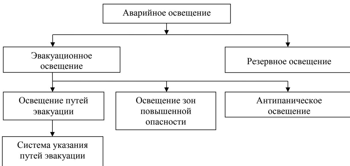
**Рисунок 4.1 – Виды аварийного освещения**
