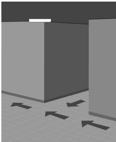
**Рисунок 5.5 – Расположение светильника эвакуационного освещения на пересечении коридоров**
