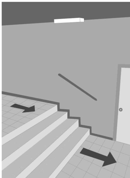
**Рисунок 5.2 – Расположение светильника эвакуационного освещения на лестничном пролете**
