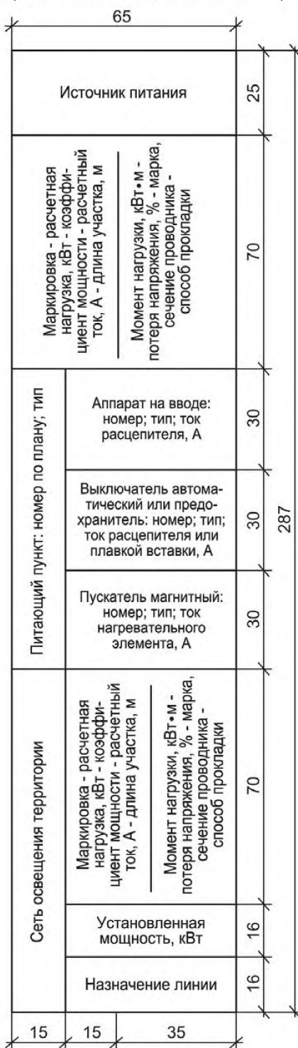
Ф о р м а 2 — Боковик принципиальной схемы питания освещения территории
