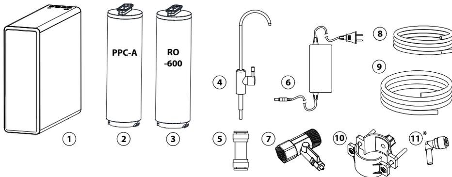
\* В комплекте с системой может поставляться дренажный ограничитель в виде углового или прямого быстроразъемного коннектора.
