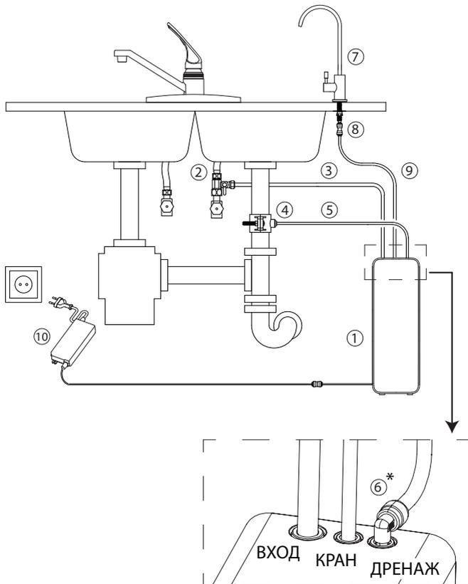
\* В комплекте с системой может поставляться дренажный ограничитель в виде углового или прямого быстроразъемного коннектора.
