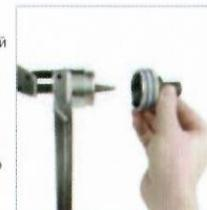
Перед вводом инструмента в эксплуатацию необходимо проверить правильно ли установлено расширительное устройство и хорошо ли оно закреплено на запрессовочных тисках (предотвращение выпадения).
