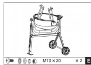
1. Установите перемешивающие лопасти внутрь нижней части барабана (показано на рисунке) так, чтобы в два отверстия в основании барабана можно было вставлять крестовые винты M10x20 снаружи. Гроверная шайба, плоская шайба, фиксирующая шайба и болт должны быть надеты свободно на внутреннюю часть лопасти. Гроверная шайба должна быть установлена между лопастью и барабаном.
