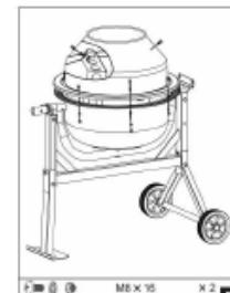
1. Расположите верхнюю часть барабана на нижней, поверх обода, чтобы отверстия и обозначенные стрелки совпали на обеих частях.
