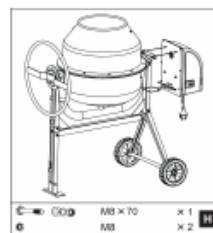
1. Наденьте короб на вал, так, чтобы все крепления совпали. Прикрутите короб к раме. Дополнительно закрепите короб на раме с помощью винта M8x70, шайбы и гровера.
