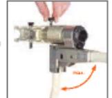
Ручной фиксаторный замок служит для закрепления насадки на вертикально расположенной трубе. С помощью ручного фиксаторного замка, можно также открутить теплоизоляцию или обфору трубу для выполнения соединения.
