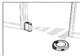
1>. После установки батарей включите питание виртуальной стены.
