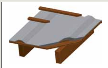
Крыши с двухслойной вентиляцией, укладка гидроизоляции поверх настила и контробрешётки
