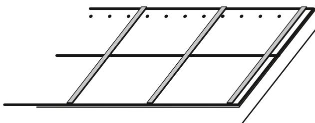
**Область применения:** Применяется в коттеджном и малоэтажном строительстве в качестве гидроизоляционного подкладочного ковра в конструкциях скатных кровель под битумную (гибкую) черепицу.
