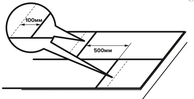
**5** При использовании в качестве временной кровли дополнительно зафиксировать рейками или пятаками с шагом 50см
