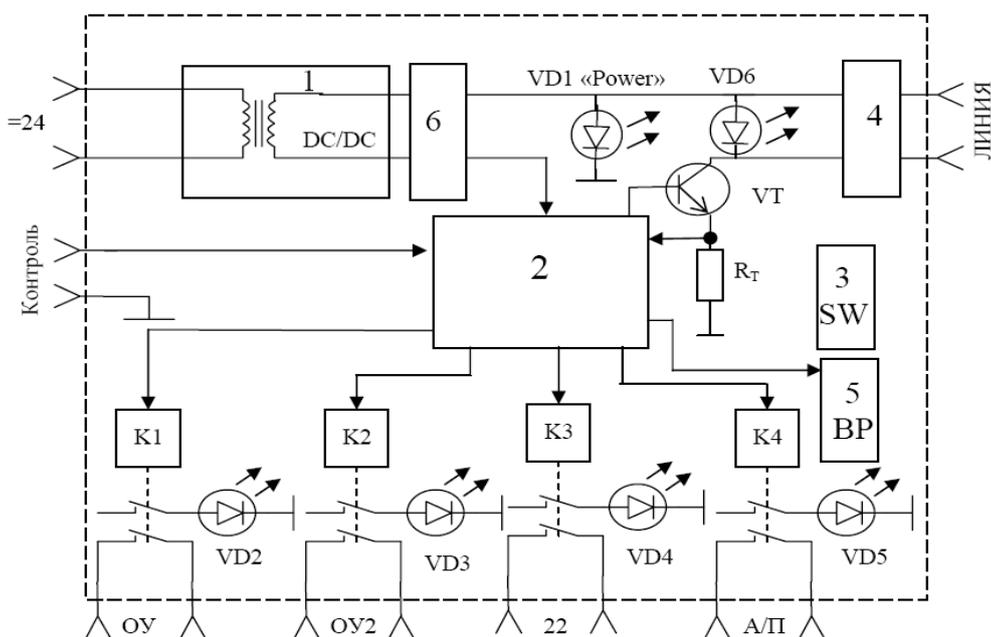
Рис.1. Функциональная схема блока питания и регистрации БПР-2.
