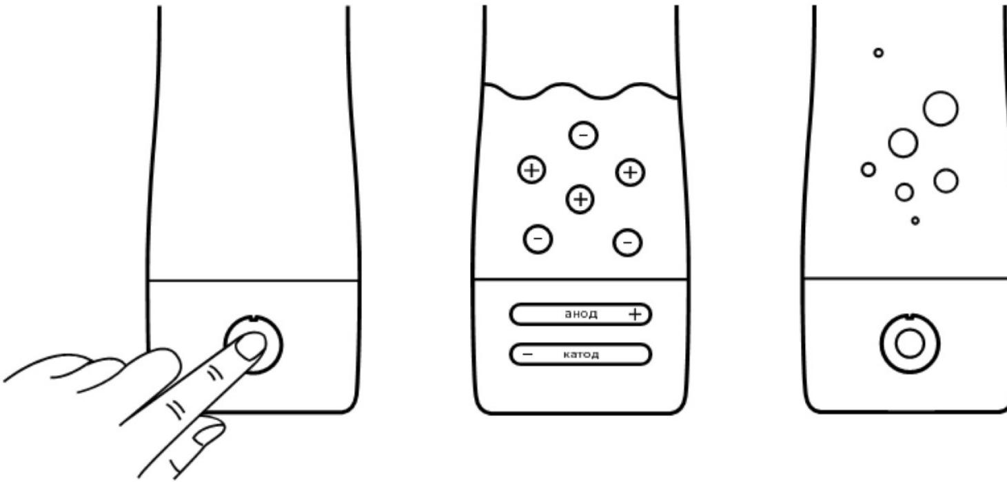
В основе работы DeAqua лежит электролиз — физико-химический окислительно-восстановительный процесс, протекающий на пластинах генератора в воде.
