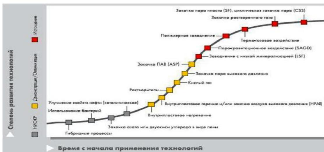
Рис. 1. График применения МУН на различных этапах разработки месторождения компании Shell.
