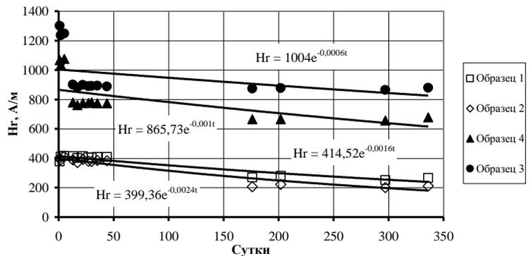
Рис. 4. Изменение напряженности магнитного поля рассеяния  $H_r$  намагниченного участка на образцах № 1–4 после отжига при 600°C.
