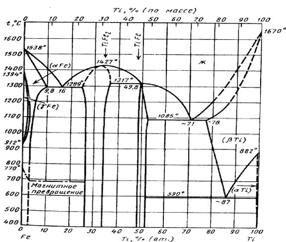
Рис. 1. Равновесная диаграмма состояния системы Fe-Ti [5].
