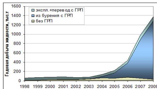
Рис. 2. Динамика дополнительной добычи нефти (а) и жидкости (б) за счет ГРП в общей годовой добыче. Объект ЮВ<sub>1</sub>
