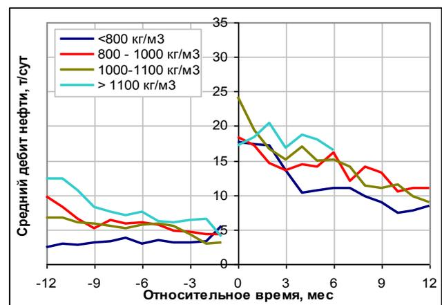
Рис. 5. Динамика средних дебитов жидкости (а) и нефти (б), приведенных на дату запуска, по группам максимальных концентраций проппанта. Скважины эксплуатационного фонда. Объект ЮВ<sub>1</sub>
