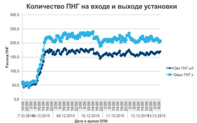
Рис. 2. Результаты опытно-промышленных испытаний технологии мягкого парового риформинга.
