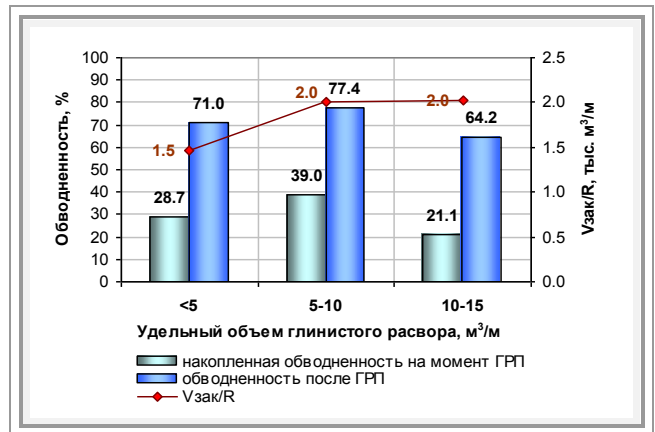
Рис. 3. Средние значения накопленной обводненности на момент ГРП, начальной обводненности после ГРП, отношения накопленной закачки по ближайшей нагнетательной скважине к расстоянию между добывающей и нагнетательной скважинами по диапазонам удельного объема закачки глинистого раствора.
