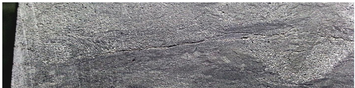
Рис. 4. Детальная съемка места раскрытия трещины в удалении от места замера МкП (специальные условия съемки, повышение контраста).
