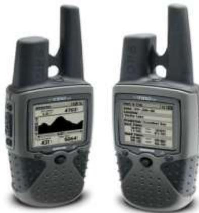
Рис. 3. Внешний вид ручного GPS приемника.
