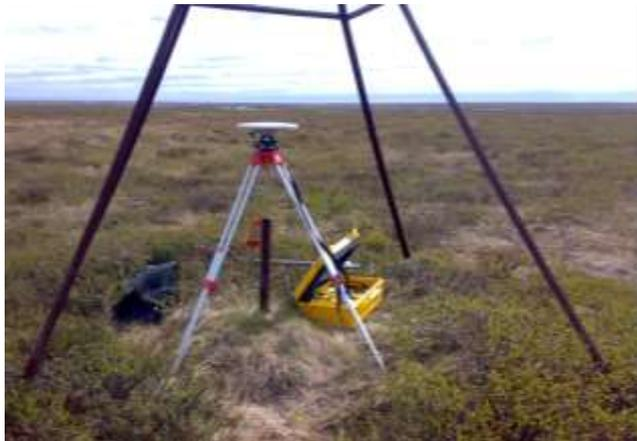
Рис. 2. Положение антенны над точкой при статической съемке.
